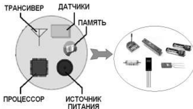
Рис.1. Состав узла сенсорной сети и его аппаратные компоненты
